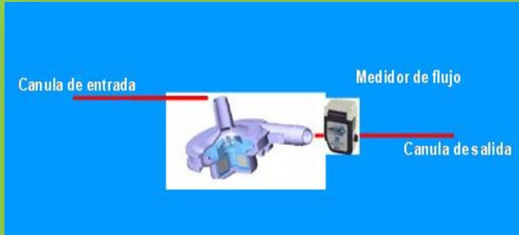
Figura 1. Componentes básicos del sistema de centrifuga. Se observa la cánula de entrada, la cánula de salida con el sensor de flujo
